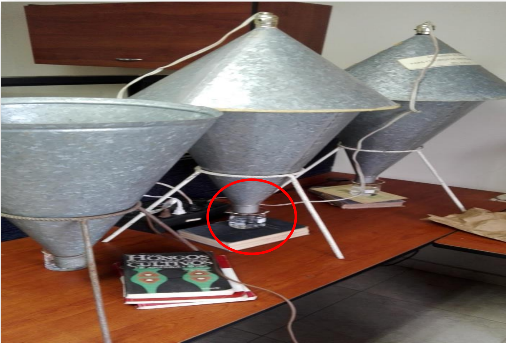
Embudo de Berlese sistema de extracción por embudo para separar los pequeños artrópodos de la hojarasca
